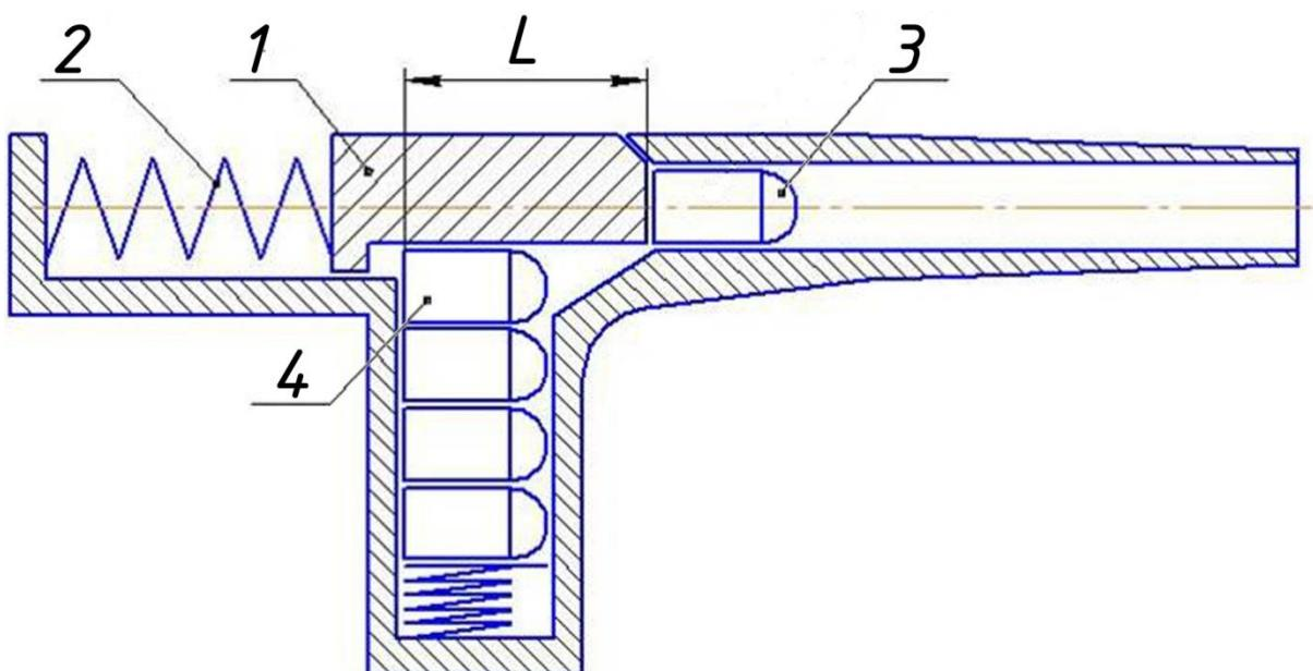
Масса вылетающего снаряда (пули) 3 составляет 0,01 кг. Масса затвора 1 0,25 кг. Дистанция подхвата патрона 4 затвором  $L = 0,08$  м. Полная дистанция отката затвора  $X = 0,12$  м. Масса досыляемого патрона 0,03 кг. В начальный момент времени пружина 2 полностью расслаблена. Начальная скорость снаряда 300 м/с.
