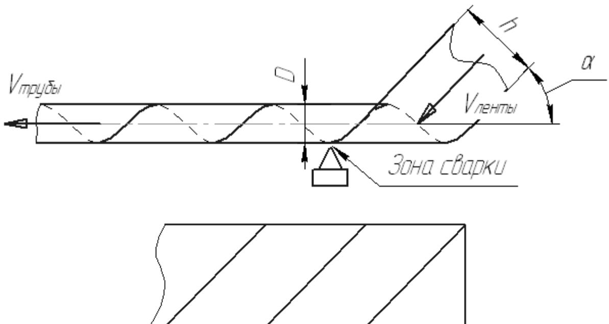
Диаметр трубы 1 м, ширина полосы 0,2 м, толщина металла 0,001 м, скорость выхода готовой трубы 0,1 м/с, теплоемкость стали 460 Дж/(кг·К), плотность стали 7900 кг/м<sup>3</sup>, теплота плавления стали 84 кДж/кг.
