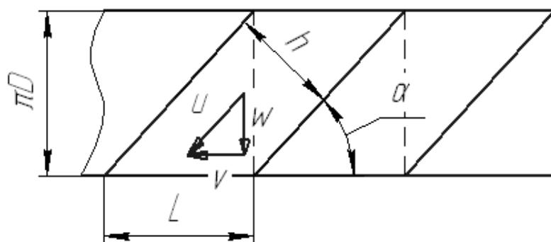
Ширина продольного раскюя равна длине окружности с диаметром трубы. В этом случае угол намотки связан с шириной ленты и диаметром наматываемой трубы. Вектор скорости подачи направлен под тем же углом, под которым подается лента. Эта скорость связана с линейной скоростью подачи трубы. Частота вращения определяется скоростью поперечного движения ленты  $w$  и диаметром трубы.
